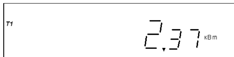
Рисунок 4.12 – Индикация активной мощности
