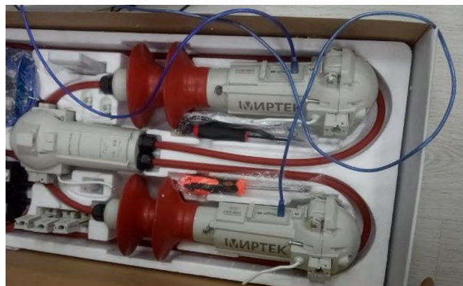
Рисунок 1.2 б. Подключение питания к ВПУ с подключенным питанием для 2-х измерительных блоков при наличии модулей связи в обоих блоках.
