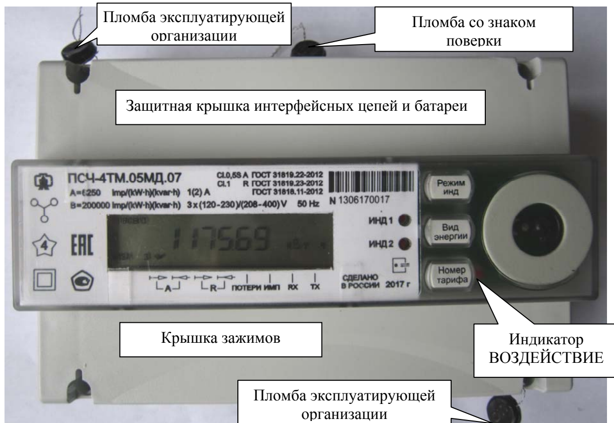
Рисунок 1 – Общий вид счетчика с закрытыми крышками, схема пломбировки от несанкционированного доступа, обозначение места нанесения знака поверки
