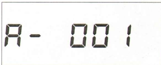
Рисунок 9 - Пример индикации адреса интерфейса RS-485 счетчика (в примере – 001)
