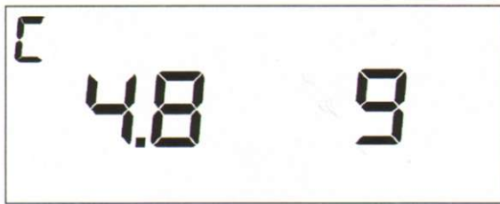
Рисунок 10 - Пример индикации скорости обмена интерфейса RS-485 и битности протокола обмена (в примере – 4,8 КБод, 9 битный протокол)
