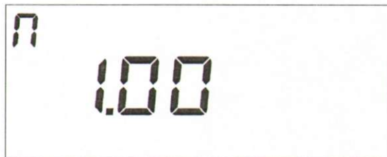
Рисунок 8 - Пример индикации версии ПО счетчика
