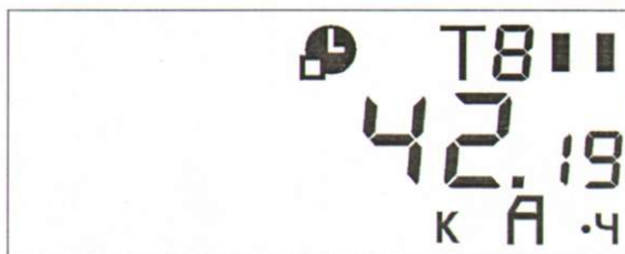
Рисунок 17 - Пример индикации удельной энергии потерь на РДЧ (текущий тариф по активной энергии- 8)
