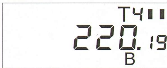
Рисунок 21 - Пример индикации напряжения сети (текущий тариф по активной энергии– 4)
