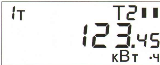
Рисунок 11 - Пример индикации текущих показаний активной энергии по 1 тарифу (текущий тариф – 2)
