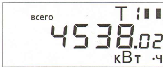
Рисунок 14 - Пример индикации суммарной по всем тарифам активной энергии (текущий тариф по активной энергии- 1).
