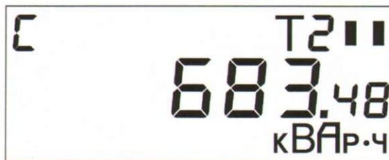
Рисунок 12 - Пример индикации текущих показаний реактивной энергии (емкостной) (текущий тариф по активной энергии – 2)
