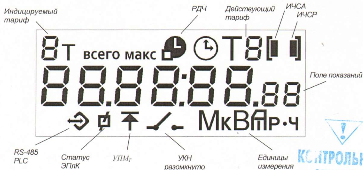
Рисунок 5 – Расположение полей дисплея счетчика
