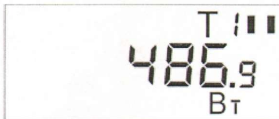
Рисунок 17 - Пример индикации удельной энергии потерь на РДЧ (текущий тариф по активной энергии- 8)
