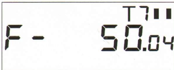
Рисунок 24 - Пример индикации частоты питающей сети (текущий тариф по активной энергии— 7)
